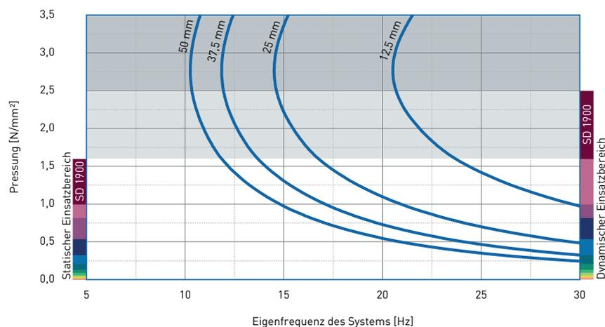
Eigenfrequenz eines Systems, bestehend aus einer kompakten Masse und einer elastischen Lagerung aus SPEBA® vibrafoam 1900 auf starrem Untergrund.
