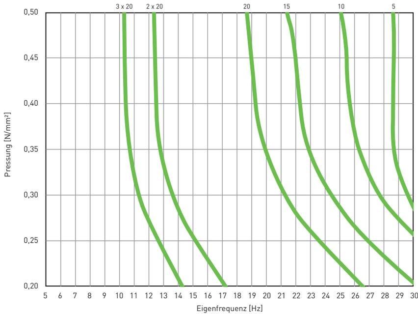
Eigenfrequenz des Systems bestehend aus einer kompakten Masse und einer elastischen Lagerung aus SPEBA® vibra ultra auf starrem Untergrund
