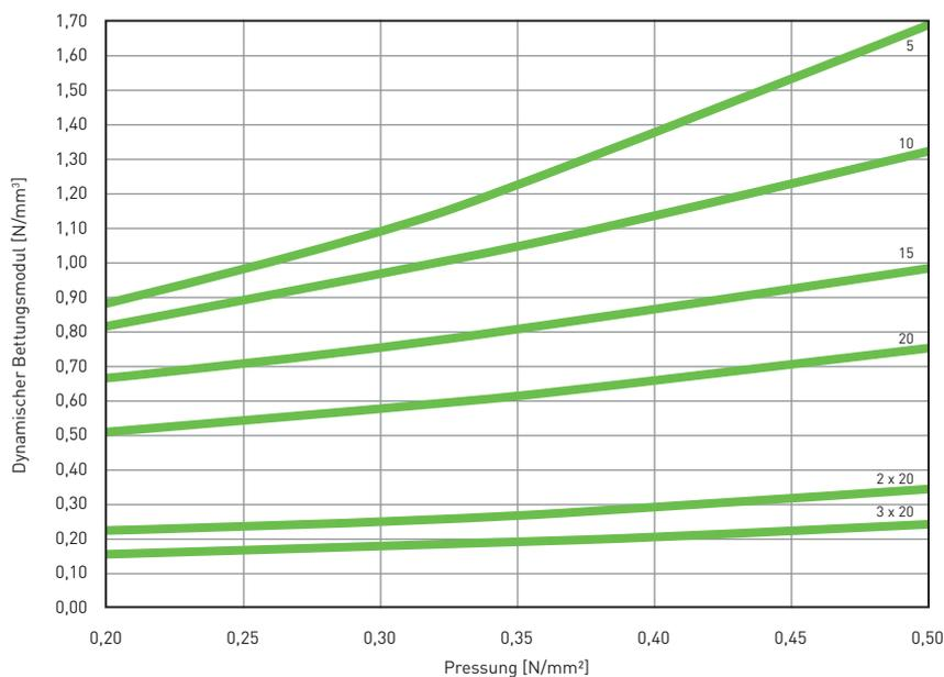
Dynamische Prüfung: harmonische Anregung mit einer Amplitude von  $\pm 0,25 \text{ mm}$  bei  $10 \text{ Hz}$
