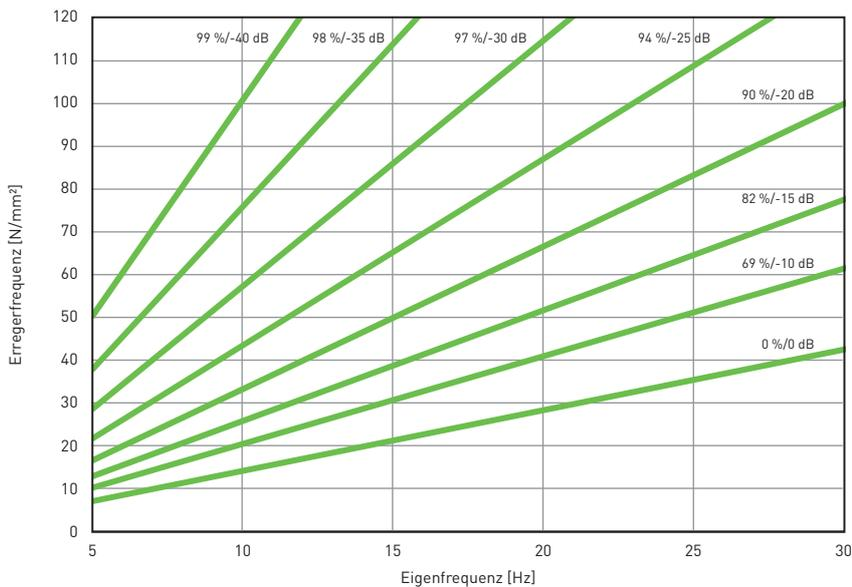
Dargestellt ist die Isolierwirkung für einen Ein-Massen-Schwinger auf starrem Untergrund mit SPEBA® vibra ultra. Parameter: Kraftübertragungsmass in dB, Isolierwirkungsgrad in %.
