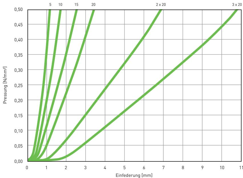
Aufgezeichnet wurde jeweils die 3. Belastung, Prüfung bei Raumtemperatur zwischen ebenen Stahlplatten.
