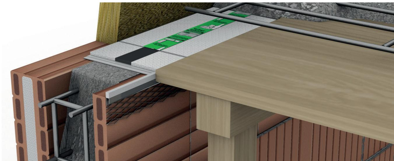
SPEBA® Streifengleitlager werden als Linienlager eingesetzt. Als Gleitlager sind sie mit speziellem Brückenlagerfett SPEBA-Dur beschichtet und zum Schutz gegen Staub im SPEBA® ScherPack-System mit aufgedruckter Einbauanleitung verlegefertig eingeschweißt. Diese Gleitlager werden z.B. unter Flachdachdecken zur Freigabe der Dilatationswege verlegt (Ringanker!).
