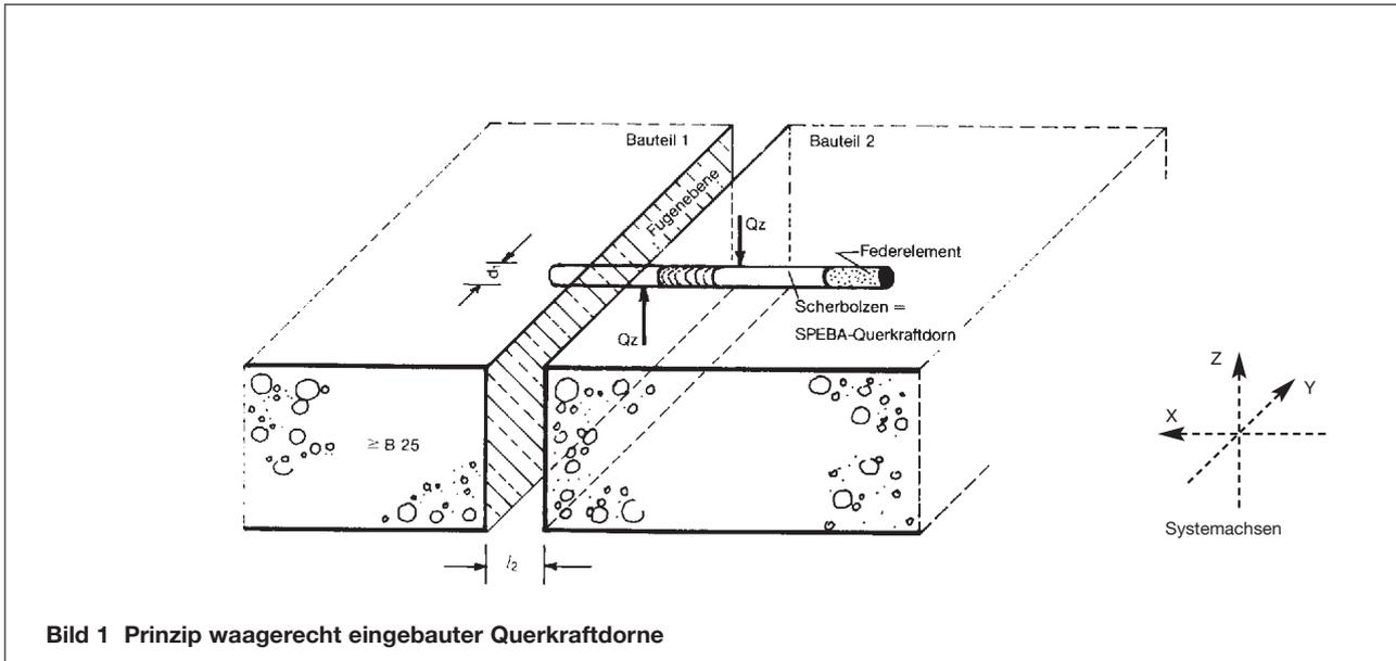
Bolzendurchmesser ( $d_1$ ), Rechenwerte für die Stahlfestigkeit ( $\sigma_{st}$ ) und Betonfestigkeit ( $\beta r$ ), Betonüberdeckung ( $\ddot{U}$ ) und Einbindelänge ( $l_1$ ) evtl. mit Zusatzbewehrung, sowie max. Fugenöffnung ( $l_2$ ) bestimmen die Belastbarkeit des Scherbolzens. Beide, Beton oder Stahl, können das Versagen der Konstruktion bewirken.
