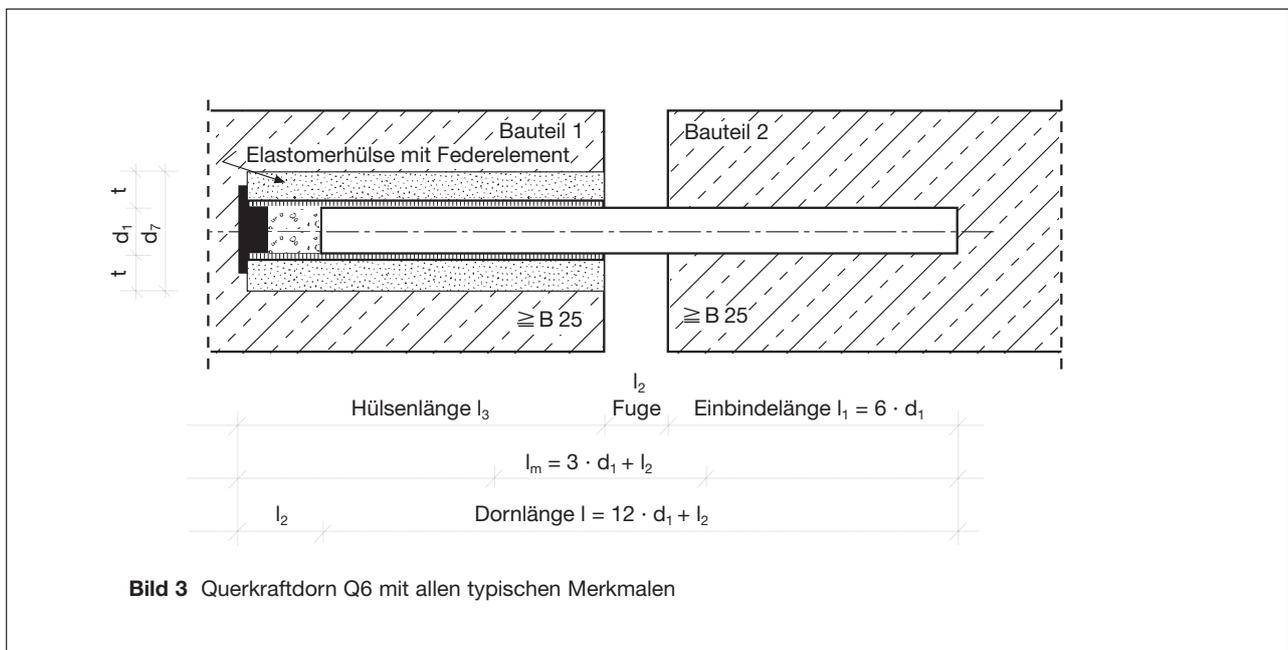
**Bild 3** Querkraftdorn Q6 mit allen typischen Merkmalen
