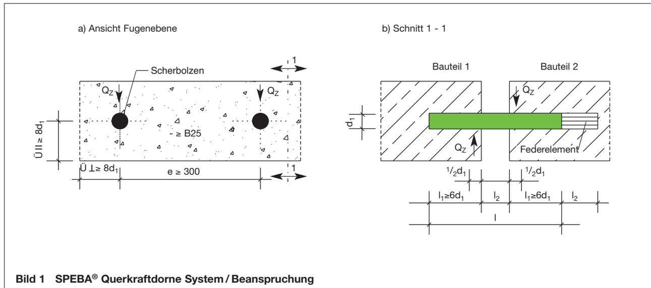
Die Bemessung erfolgt getrennt für den Stahldorn bzw. den Beton, da sowohl zu hohe Biegebelastung des Dornes als auch zu hohe Betonpressung/Aufspalten das Versagen der Konstruktion bewirken können.
