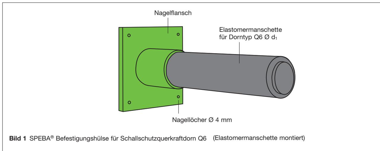
Vor der Montage wird die Elastormanschette des Querkraftdornes Q6 in die Befestigungshülse eingesteckt und dann an die Schalung festgenagelt. Die Schalung muss nicht mehr durchbohrt werden. Es folgt das Einbetonieren der Hülse. Vor Beginn des zweiten Betonierabschnittes wird der Stahlstab in die Hülse eingesteckt und einbetoniert. Der Einbau des kompletten Dornes erfolgt genau rechtwinklig zur Schalungsebene.
