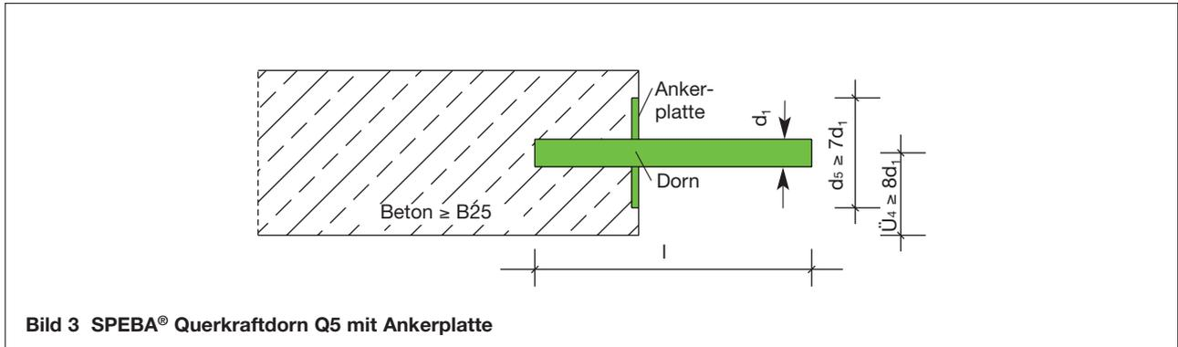
Bei Betonüberdeckungen  $\bar{u} \leq 8 d_1 \geq 3 d_1, \geq 65$  mm wird durch geeignete Bewehrungsanordnung (siehe Bild 4) die zul. max. Beanspruchung  $Q_{max}$  bis zur zul. Biegebeanspruchung des Stahldorns erhöht:
