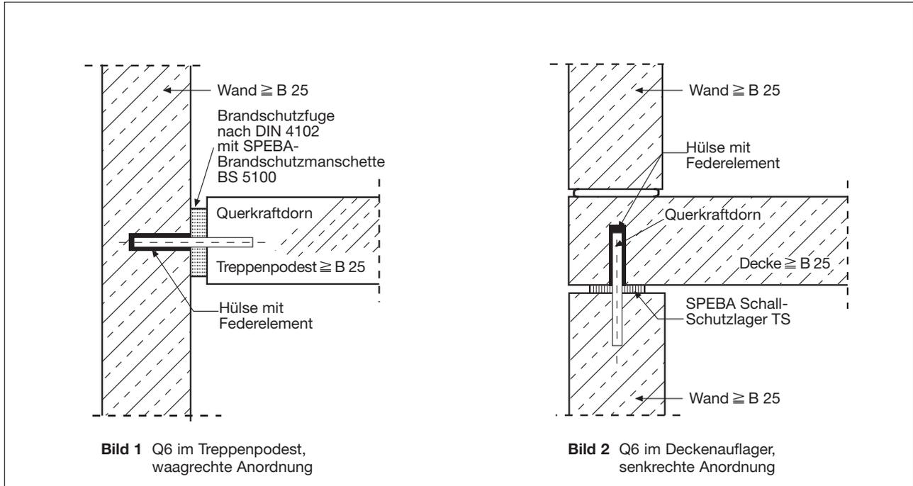
Der Standard-Dorn ist für eine Fugenöffnung von  $\leq 30$  mm ausgelegt. Er wird in den Stahlqualität St. 52 verzinkt und Edelstahl V4 A E 355 Festigkeit = St. 52 (Werkstoff-Nr. 1.4571) gefertigt. Die Mindesteinbindelänge wird mit  $l_1 = 6 \cdot \text{Dorndurchmesser}$  vorgegeben.
