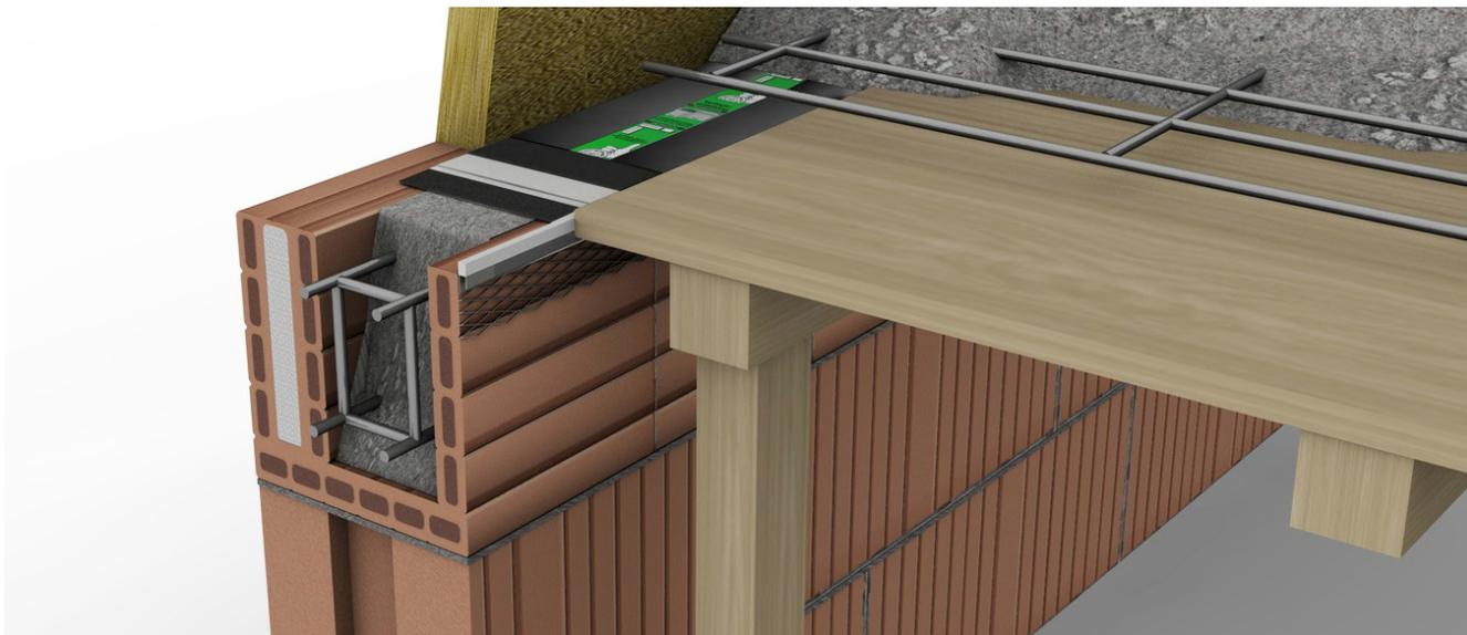
SPEBA® Gleitlager der Serie F 30 / F 150 sind mit SPEBA-Dur beschichtet und zum Schutz gegen Staub im SPEBA® Scher-Pack-System mit aufgedruckter Einbauanleitung verlegefertig eingeschweißt. Sie werden als Streifen in Mauerwerksbreiten geliefert und z. B. unter Flachdachdecken zur Freigabe der Dilatationswege verlegt. Deckenschubrisse werden so vermieden. Die Stöße werden mit SPEBA® Abdeckband abgeklebt.
